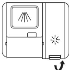
Снять крышку дозатора, поднимая за ручку.
