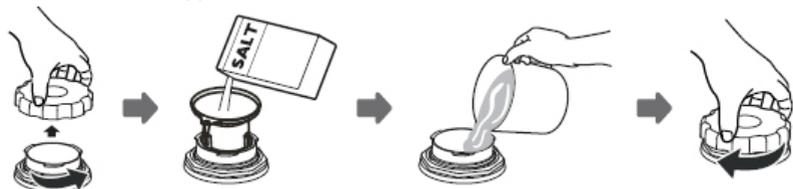
1. Извлечь из устройства нижнюю корзину открутить крышку дозатора.
