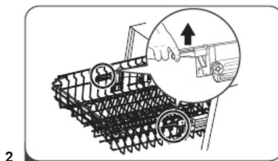
1. Чтобы поднять корзину в верхнее положение, следует поднять ее с обеих сторон на одну высоту. Убедиться, что она хорошо зафиксирована на направляющих.
