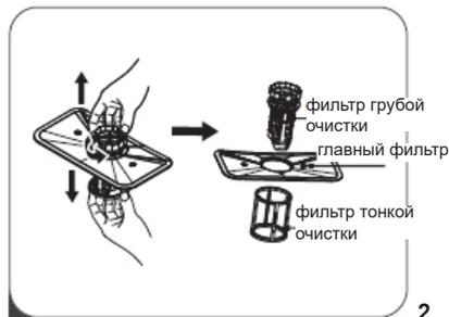
1. Взяться за фильтр грубой очистки и повернуть его влево, чтобы открутить. Поднять фильтр вверх и извлечь из машины.
