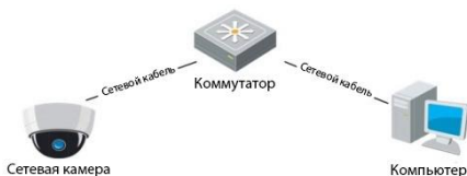
Рисунок 3-2 Соединение через коммутатор или роутер
