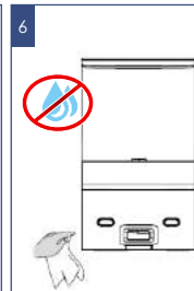
При необходимости, протрите сухой тканевой салфеткой внутреннюю полость пыленакопителя
