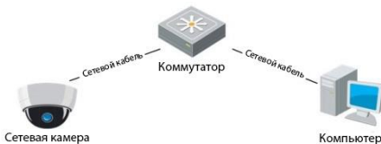
Рисунок 3-2 Соединение через коммутатор или роутер
